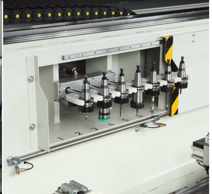
Changeurs d'outils à 7 positions
