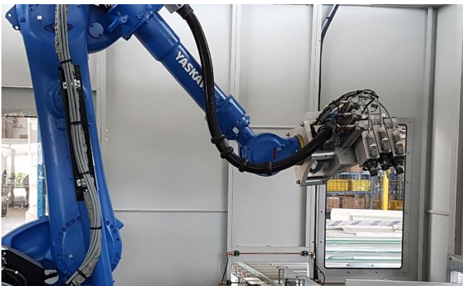
Équipé jusqu'à 6 broches d'usinages 24 000 t/min
