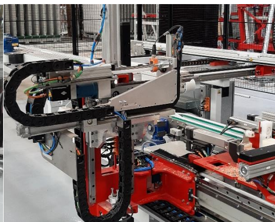
Positionnement numérique des têtes de vissage avec 2 chariots numériques face à face
