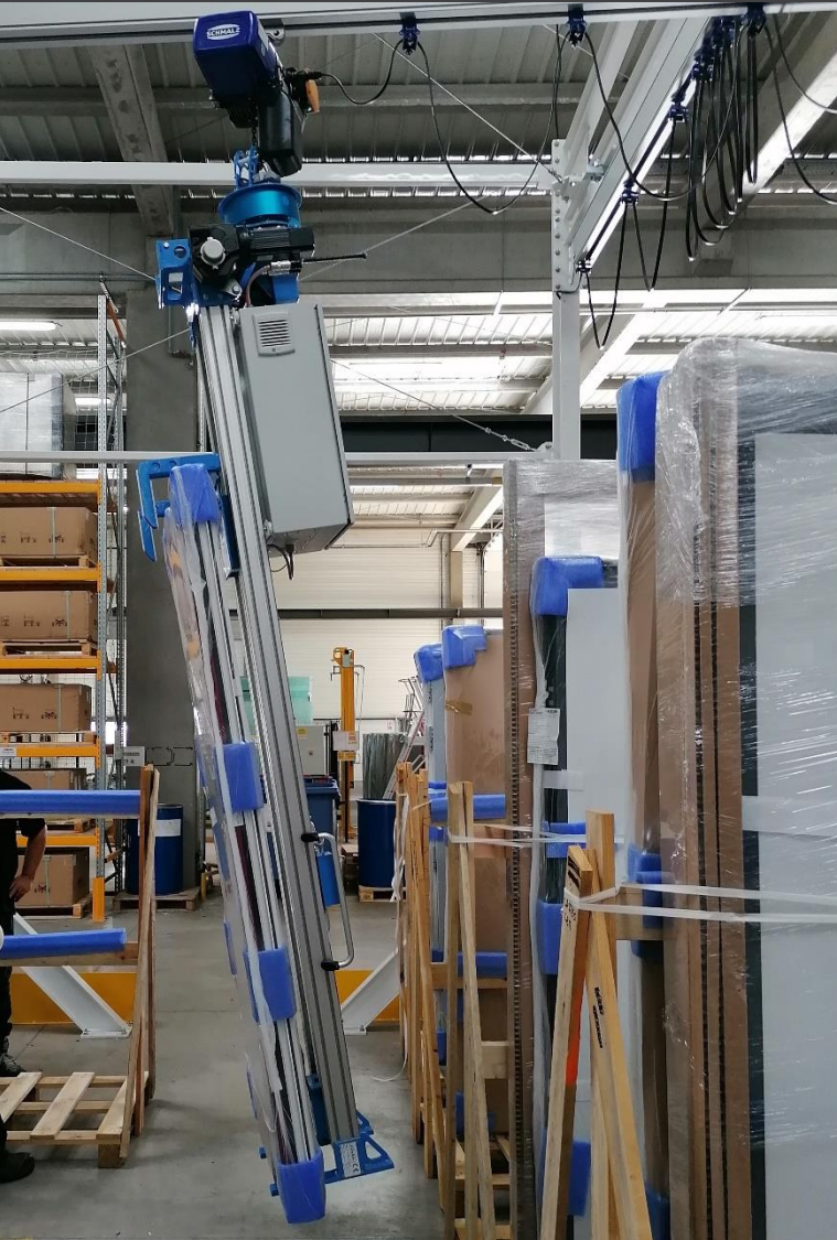
LLP – Préhenseur à pince électrique pour les menuiseries et portes emballées, non manipulables avec un préhenseur à ventouses
